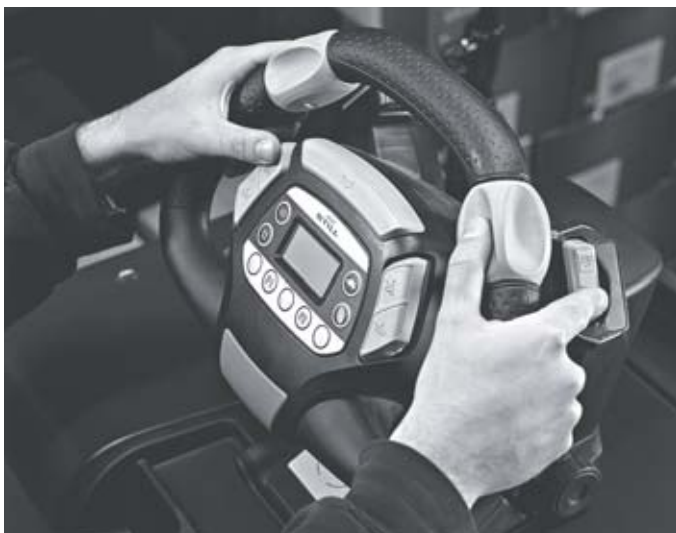
Volant unique STILL Easy Drive pour un meilleur confort de conduite et une utilisation facile de toutes les fonctions sans lâcher le volant
